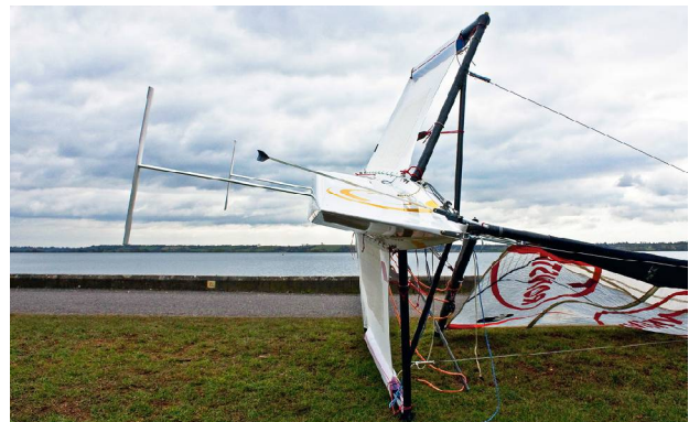
Das Leichtgewicht Moth Mach 2 (segelfertig ca 35 kg) ist leicht zu legen. Sehr gut sieht man die T-Hydrofoils.
