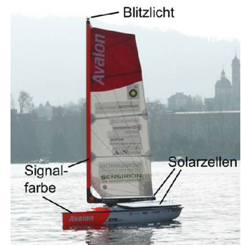
Die Avalon, das autonom segelnde Boot, allerdings ohne Hydrofoils.
