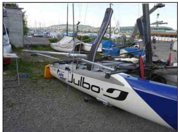
Das Boot nach Zusammenbau. Deutlich sieht man die j-Foils, die mit Talljen gesetzt und eingestellt werden.
