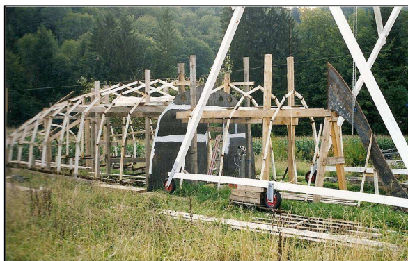
Die ausgerichteten Spanten, fast fertig zur Beplankung
