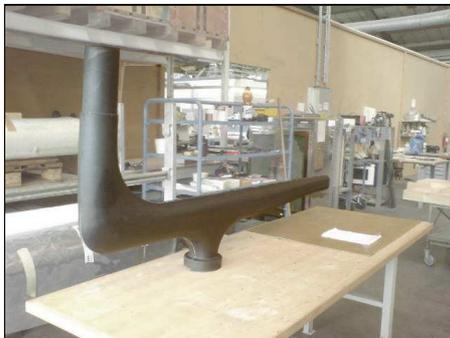
Mast-Baum-Winkel mit zurückgelegter Drehachse, aus kohlenfaser-verstärktem Polyurethan verbacken.
