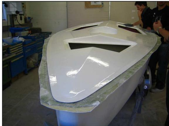
Der selbst aufgebaute Bootskörper aus GFK.
