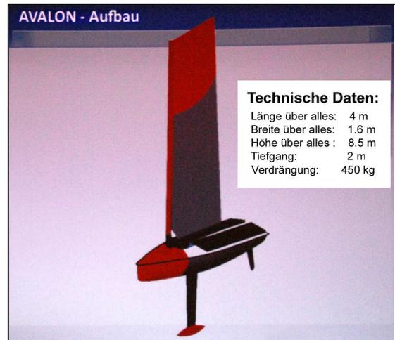
Aufbau mit Ballastkiel und technische Daten
